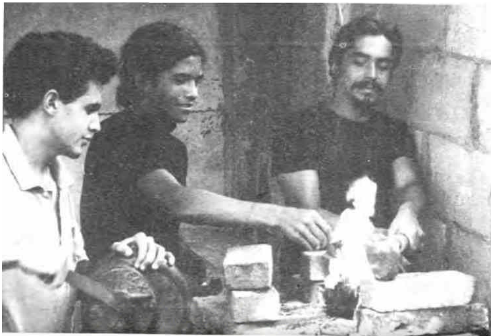
Aprendices de artesanos se preparan para derretir plata en una fragua casera. A la derecha Fernando Rocha Pitta, pintor, miembro del equipo de trabajo del Proyecto y coordinador de los cursos.
